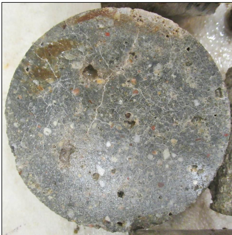
Foto 9: Pohled na trhliny na líci v první části vzorku N3 (169,558-169,738) po zkoušce mrazuvzdornosti – 75 zatěžovacích cyklů
